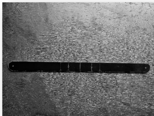
58. ábra: Himbatartó konzol előrajzolás – saját felvétel
