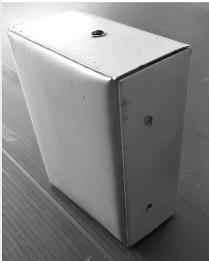
Gépház- Hátfal összefordítása
