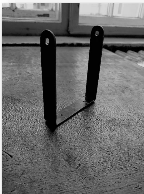
58. ábra: Himbatartó konzol előrajzolás – saját felvétel
