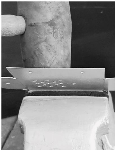
Első oldal hajlítása satuban.
