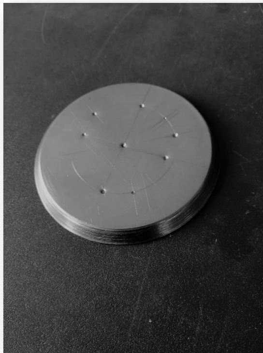
54. ábra: Alsó nagytányér előrajzolt – saját felvétel
