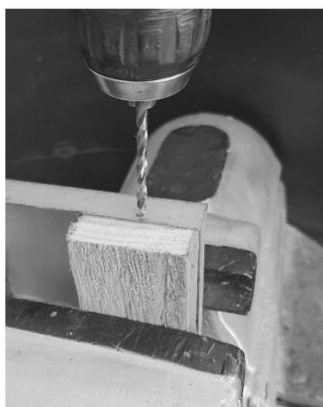
Hátfalon furatok készítése, távtartó közbeiktatásával.
