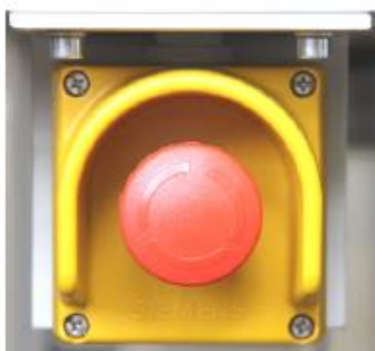
68. ábra: Vész Stop nyomógomb a robotcellán
