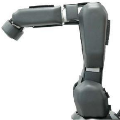
82. ábra: Hat szabadságfokú kollaboratív robotkar érzékelőbőr rendszere
