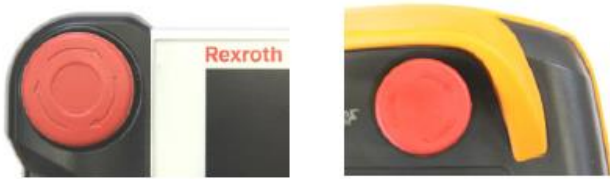
69. ábra: Vész Stop nyomógomb a mobil kezelőpanelen
