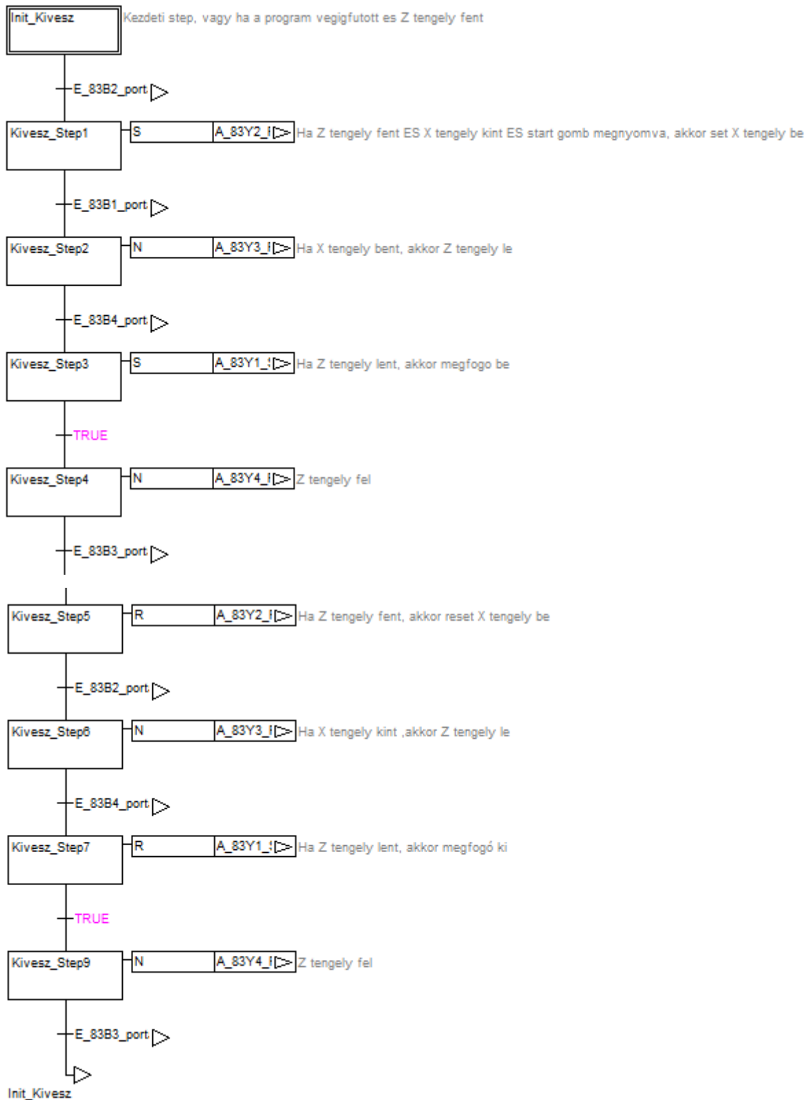
41. ábra: A présgépből való kivétel programkódja
