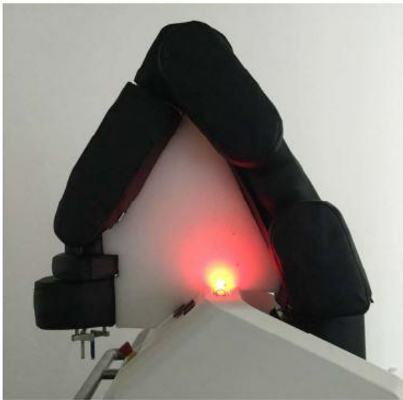
110. ábra: Az érzékelőbőr átkötése
