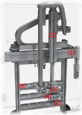
17. ábra: A harmadik állomáson található tár és mozgató egység
