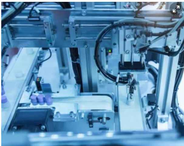
113. ábra: Hibrid rendszer pneumatikus, elektropneumatikus és elektromos tengelyekkel
