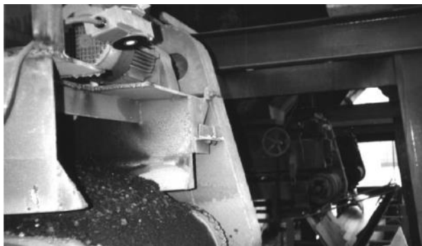
61. ábra: Torlódás ellenőrzése ömlesztett anyagot mozgató szállítószalagon
