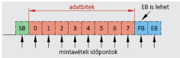
130. ábra: Alapsávi átvitel aszinkron időkeret (UART karakter)
