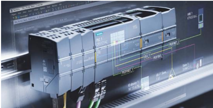
147. ábra: PLC webszerver megoldás
