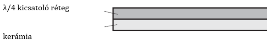
47. ábra: \lambda/4 negyedhullámú rezgőelem vázlata
